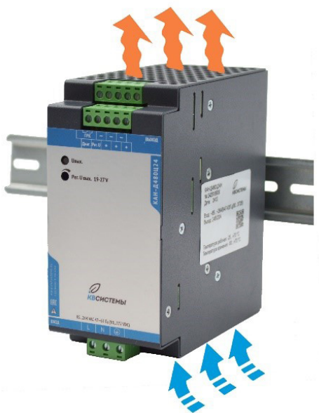
Рисунок 4 - Принцип охлаждения при естественной конвекции
